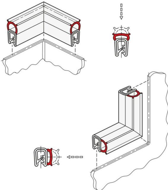
**Elesa+Ganter denkt stets einen Schritt voraus und komplettiert nun seinen Produktbereich der Kantenschutzprofile um Dichtprofile mit vorgefertigten 90°-Ecken.**
